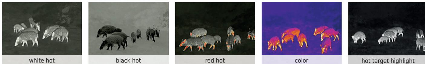
Die Infrar Wärmebildgeräte ermöglichen in neuester Generation von Sensortechnik ein sehr kontrastreiches Wärmebild. In den Geräten sind die neuen 12µm Keramikdetektoren von IRAY verbaut. Die Wärmebildgeräte verfügen über einen stromsparenden Keramik-Detektor und je nach Modell das passende Objektiv. Mit diesen Geräten sind Bilder in sehr großer Distanz und bei widrigen Wetterbedingungen möglich. Das integrierte manuell fokussierbare Objektiv ermöglicht scharfe und kontrastreiche Bilder.
